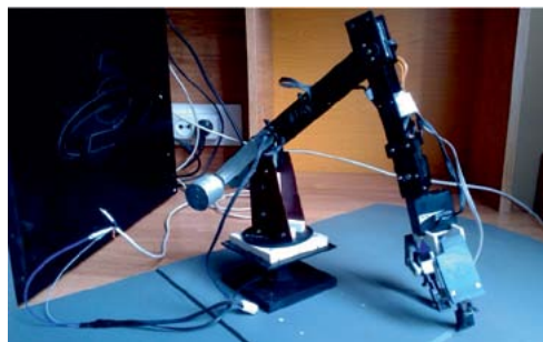
Рисунок 1 – Стенд, демонстрирующий работу робота-манипулятора для задач малоинвазивной хирургии
